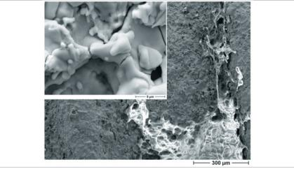
Straumann Tissue Level Explantat mit Titan-Plasma-Spray "TPS" Oberfläche nach Reinigung mit neuem Verfahren Foto: Zipprich
